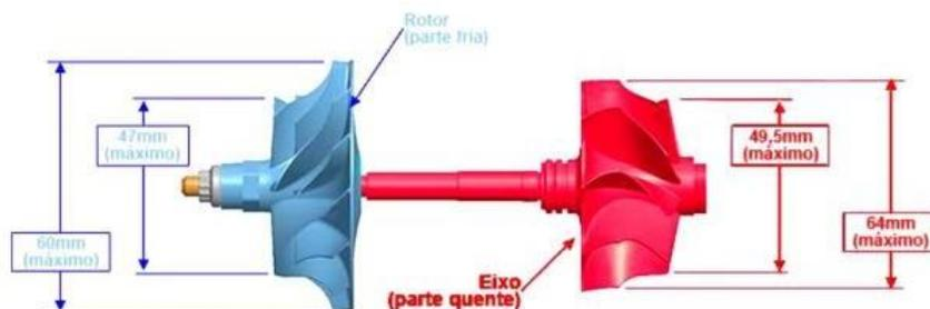
Obs: Essa progressão de medidas dos rotores (inducer e exducer, conforme foto acima) deve ser feita de forma linear. Cujo o tamanho máximo do diâmetro interno da carcaça fria (Compressor cover inducer) onde o rotor tem a medida máxima de 49,5mm, deverá ser de no máximo 51mm.
