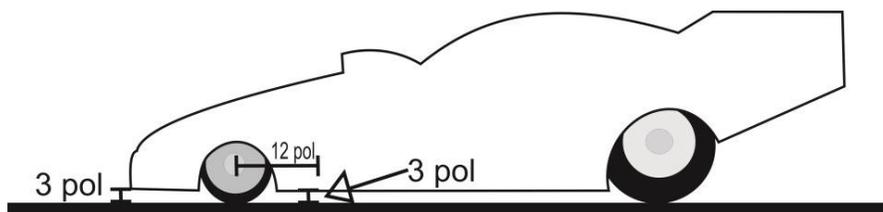
b) Proibida a suspensão rígida e travamentos de suspensão, podendo o veículo ser somente rebaixado, mas seguindo a altura padrão. Os amortecedores podem ser substituídos por outros de maiores cargas.
