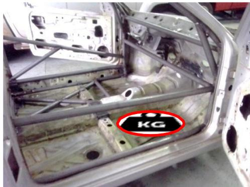
34.6.1 – A fixação do lastro deverá ser feita com, no mínimo, dois parafusos de aço de 10mm de diâmetro, com porca e contra-porca, de tal forma que permita uma lacração efetiva pelo comissário técnico.
