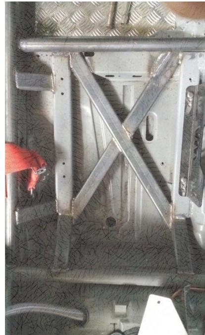
35.5 – A fixação do banco deve ser feita através de seu suporte lateral e, com no mínimo, quatro parafusos de 8mm de diâmetro ou mais.
