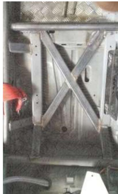
**47.3.2** – A fixação do banco deve ser feita através de seu suporte lateral e, no mínimo, quatro parafusos de 8 mm (oito milímetros) de diâmetro ou mais.
