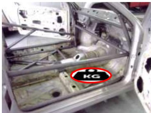
**46.2.1** – A fixação do lastro deverá ser feita com, no mínimo, dois parafusos de aço de 10mm (dez milímetros) de diâmetro com porca e contra-porca, de tal forma que permita uma lacração efetiva pelo comissário técnico.
