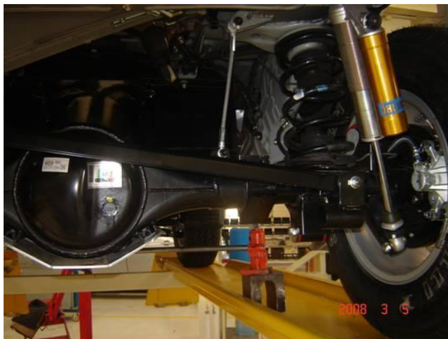
Figura C4: Eixo traseiro com os limitadores instalados.
